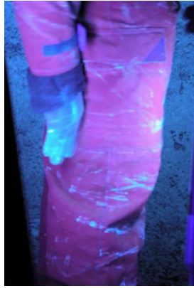
Figuur 5. Zichtbaar maken van huidblootstelling via toevoegen een fluorescente tracer in de gewasbeschermingsmiddelen van een fruitteiler (met dank aan Andrea Hiddinga, Arbo Unie).
